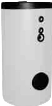
Trattamento interno con resine termoidurenti, completo di protezione catodica mediante anodo al magnesio premontato, finitura esterna in PVC e rosette per manicotti. Isolamento in poliuretano morbido spessore 100 mm assemblato sul corpo bollitore.
